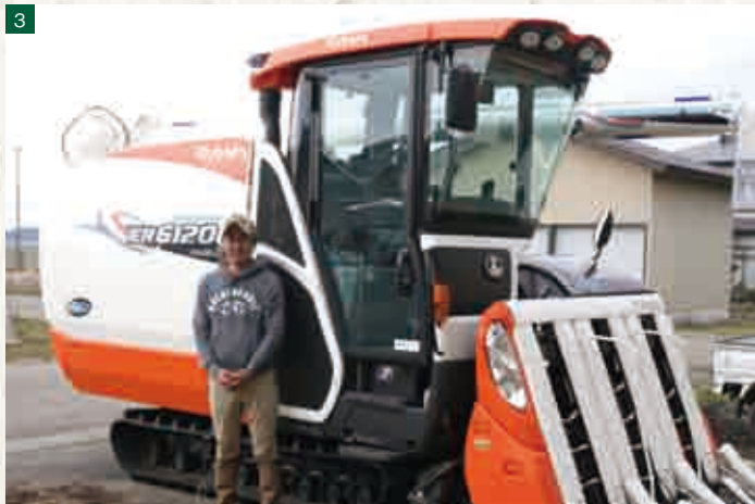
1 K-SASシステムの端末でオペレーターからの情報が会社に現地から飛んでくる 2 画面にパソコンから飛ばしてみんなで共有している 3 収量、タンパク含量などを収穫時に把握できるクボタの最新鋭コンバインER6120（6条刈・120ps）
