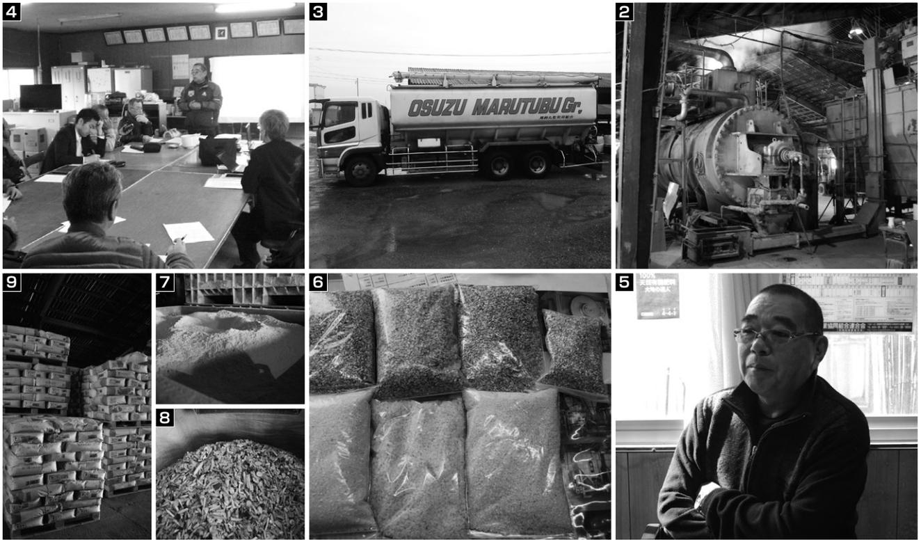
2 飼料工場の中央にある大きい機械にすべての原料を入れて熱処理した後、乾燥して、ふるいにかける 3 宮崎サンエフの丸粒トウモロコシ輸送用の専用トレーラー。鹿児島県の志布志港と往復する 4 宮崎での検討会の様子 5 飼料配合に精通した遠藤威宣社長 6 原料に使用している飼料用米のサンプル 7 8 9 飼料工場に持ち込まれる食品廃棄物は、賞味期限の切れたお菓子など多様である
