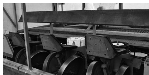
1分間にパラシュートのように60苗落とし、機械で定植している
