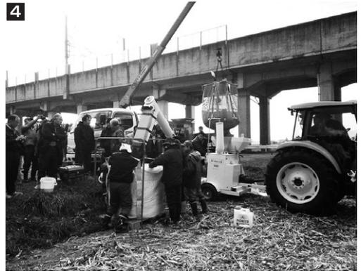
1 収穫実演をしたクラス・アベロ 240 (エム・エス・ケー農業機械(株)提供) 2 開発中の国産汎用コンバイン (ヤンマーアグリジャパン(株)提供) 3 収穫直後の子実トウモロコシ 4 収穫したままの水分状態で粉碎する。粉碎機は PERUZZO-500 (株タカキタ提供) 5 粉碎後のトウモロコシ 6 粉碎したトウモロコシは乳酸菌を添加した後、フレコンに袋詰めして脱気・密封し、HMSCサイレージ化させる
