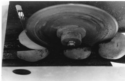
V字型のベルト搬送であるため、左右ほぼ均等の大ききで切断できる。円板刃の上から消毒液を点滴しているので、ナイフの消毒は的確に行なわれて、病害がまん延するようなことはない。
