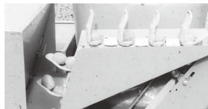
カップコンベアはタンクの底部から1粒以上汲み上げて上部に到達する。ここでコンベアは横移動となり、カップは縦になる。余分な塊茎は落とされてタンクに戻る。世界的にポテトプランターはこの形式のものが多いが、確実にカップに1塊茎にする精度に配慮している。
