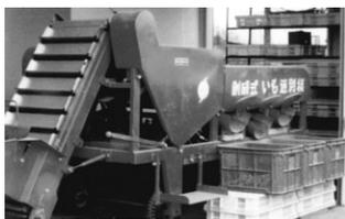
現在のメカトロ技術を使えば、選別精度は高くできる。しかし、経費面を考慮すると、大量処理でなければ、物理処理が妥当である。選別機はいろんな形態のものが開発されているが、扱いやすく、選別精度の高いのは回転ローラー方式である。搬送過程でローラーの間隙を変えて選別する。
