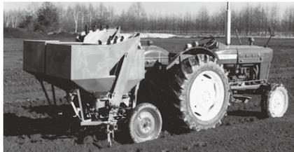
傾斜円板型のポテトプランターは、我が国独自のものです。単純な構造であるところから価格も安い。しかし、補助作業者を必要とするので省力化するため、全自動型のカップコンベア式を検討した。種イモの切断装置を取り付けて、高効率播種が可能である。
