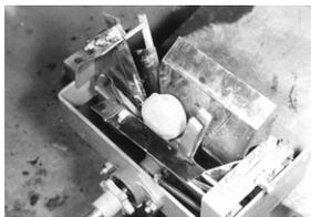
開発当初の切断装置。馬鈴薯の左側が固定ナイフで、右側が回転フォーク（アーム）である。この時点では切断抵抗が大きく、実用化が危ぶまれた。ナイフの取り付け法を変え、回転フォークを若干長くし、種イモを囲むように湾曲にした。種イモが回されながらナイフに当たっていくので、切断抵抗を少なくできた。
