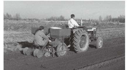
前部に施肥装置が取り付けられている。12cmの幅で開溝し、そこに施肥する。その上5cmの厚さで土を戻したところに播種する。種イモの深さが5cmの深さになるよう土を寄せ、最後部鎮圧輪で軽く鎮圧して播種完了となる。
