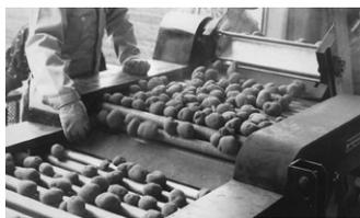
右手からバケットコンベアで原料を供給する。塊茎は回転するローラーコンベアで搬送されるが、第一の工程は土砂抜きである。次のローラーコンベアに移されると、ローラーの間隙が広がるので、そこから順次大きさに選別され、排出口に落下する。ローラー自体の回転にはトルクリミッターが付いており、塊茎が挟まって傷つくことはない。
