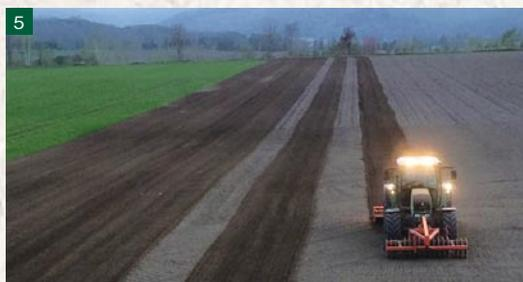
1 植え付け前は、フロントに砕土・鎮圧作業機、リアにパワーハローのコンビ作業で効率よく行なう。フェントのトラクターは操作性に優れるので良き相棒だ 2 ジャガイモの培土作業。GPSガイダンスと自動操舵装置を活用して、変形圃場でも円弧を描くように美しい畦づくりができる 3 トラクターの内部に装着したGPSガイダンスの画面。傾斜圃場が多く、高低差が色の違いで表示されている 4 トラクター後方につけたカメラの画像も同じ画面で映し出せる。肥料の残量確認に便利 5 夜間はLEDの作業灯をつけて、GPSガイダンスを活用している
