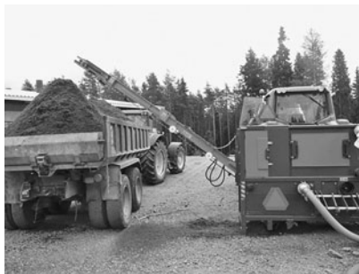
小型スラリーセパレータのミルストン50型は、1時間に50~80m 3 のスラリーを処理できる。
