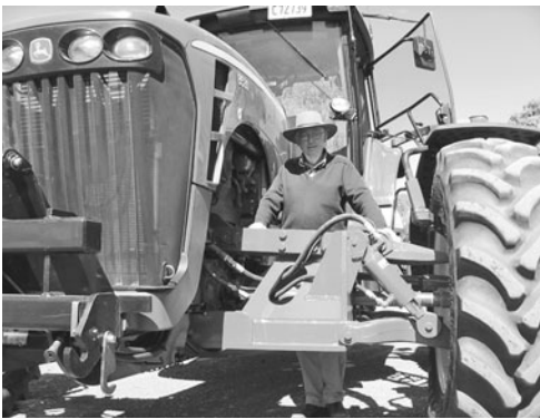
農業経営者ジョン・フォーリー氏は、前輪にILSを搭載したジョンディア社製トラクタの車幅を3m広げる改造方法を開発した。
