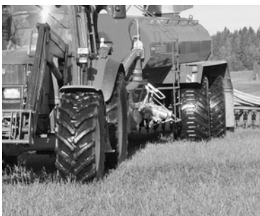
アグロニック社は、2車軸と3車軸のスラリー・タンカーの車体に別料金でクラブ・ステアリングを搭載することを推奨している。
