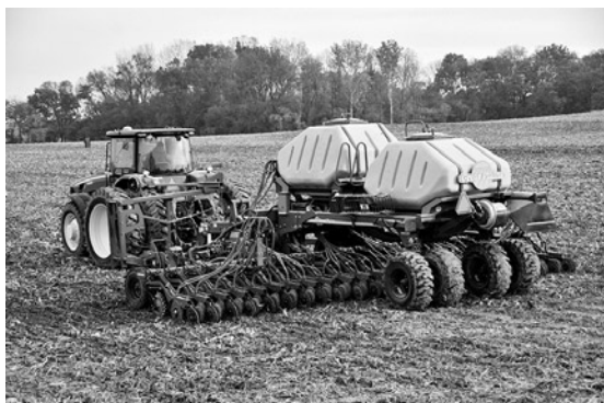
米国のグレート・プレーンズ社製ドリルは幅9m。しかし走行時には3分割折りたたみ方式によって車体の前と下に格納され、車幅は3mになる。
