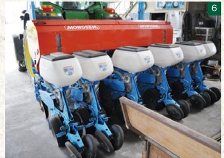
6 モノセムの大豆播種機。作業速度は時速7～8kmで、10aあたり3分ほどで播種作業を行なえる。7 大豆と小麦はクボタの汎用コンバインARH900で収穫。8 モロオカのクローラトラクタMK140。泥炭地の多い津軽平野では重宝する。9 スガノ農機のプラウは18インチの4連リバーシブルを使用。10 ブランシャのブームスプレイヤー。大豆の防除や土壌処理に活躍。
