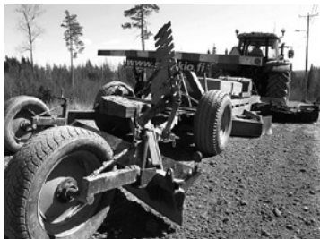
ソウキオ社製のプレーナー（路面切削機）は農業者と農業コントラクターが愛用している。
