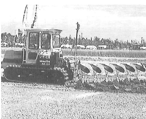
ブラウにレシーバを取り付けてレーザーの指示通り水平に、あるいはある勾配で耕起する。量盛が一定になるとビネーションである。路上走行時は、折りたたんで幅を狭くする構造になっている。
