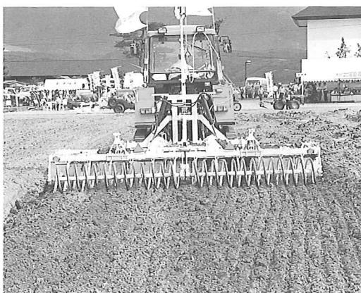
後方からみた状態。コイルバッカが作用して仕上がりがきれい。スプリングタインの砕土とコイルバッカの見事なコンビネーションである。路上走行時は、折りたたんで幅を狭くする構造になっている。
