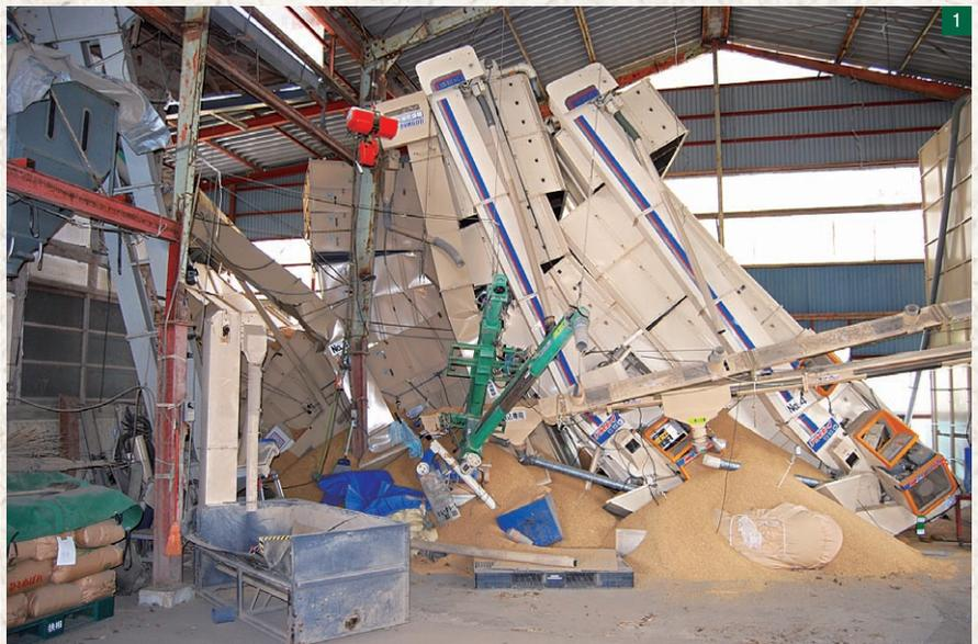
1 3.11の大震災によって倒壊した乾燥機。中に貯蔵していた籾が床に散乱した。これを片付けることから伊藤農場の復旧が始まった。2 震度7という揺れのために農道には鋭い亀裂が入った。3 倉庫に2段に重ねられた籾の入ったフレコンバック。倒壊してシャッターが破壊されたため、鉄骨の支えを設置した。4 落ち着かない日々の中、作業を進めた伊藤一家。なお1は2011年3月11日、2～4は同年4月に撮影。
