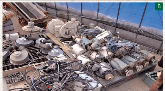
5 現在は稼働している乾燥機。倒壊被害を免れた乾燥機と提供されたものを組み合わせている。6 長野県諏訪市の農業経営者、山田三夫（山田ライスセンター）は「更新を前倒しするから」と無償で乾燥機を提供。7 また山元町の農業法人、黄金ファームから提供された乾燥機は津波の被害を受けていた。赤い線は津波の到達水位。8 分解された乾燥機から取り出されたモーターやファン。部品はスペアや修理のために保存してある。
