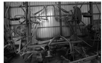
▲レーキUM410（ストール社）は反転と集草両用。回転が速く、麦わらを傷めずにまとめて散らす。競馬場向けに麦わらロールを出荷。
