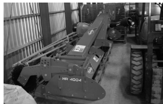
▲パワーハロー HR4004（クーン社）。カゴローラは大径で土抜けの良いレムケン製品に交換。「土がこなれて、仕上がりが違う」と話す。
