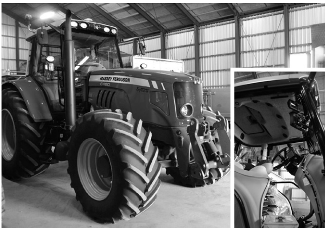
昨年導入した、MF6480 Dyna-6（145馬力）。フロント3点リンク、トリンプ社製のGPSガイドシステム、オートステアを取り付けた。畝切り、ジャガイモの植付け、小豆の播種などの作業で活躍。「振り返る姿勢が減り、身体が楽になった。次の日も続けて作業ができる」と導入効果を評価している。
