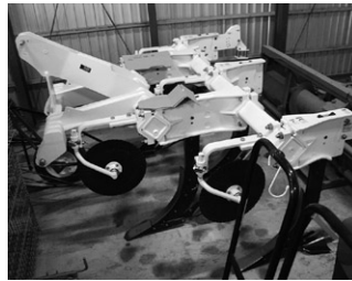
▲今年納入したプラソイラ（スガノ農機）。全体を軟らかくすると踏圧の影響を受けるため、あえて爪の間隔を広げて55cm→60cmに。
