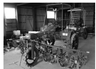
▲管理作業機HSTMD14（ヤンマー）は小豆用のカルチ用。みのる産業のRT30と2台体制。雑草の状況に合わせてアタッチを選ぶ。
