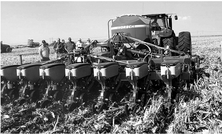
ホーシュ社の条耕起播種機Focus TDシリーズは荒れた土地でも、前作のトウモロコシの残渣物の上に直接播種できる。
