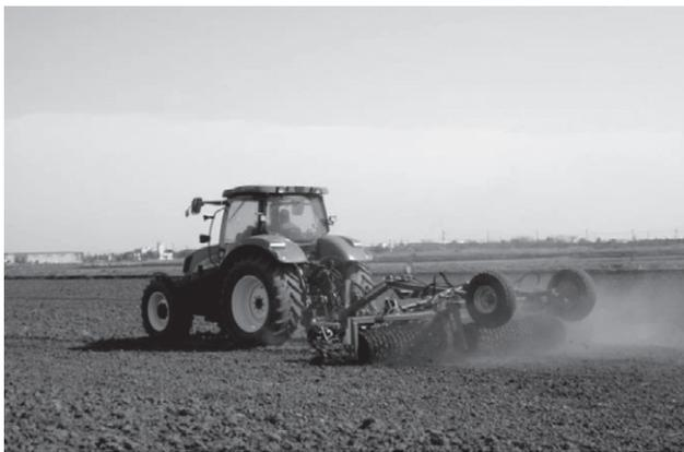
図4：ケンブリッジローラーによる鎮圧作業
