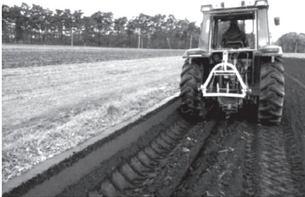
図2：畦畔際のトラクターホイールによる鎮圧
