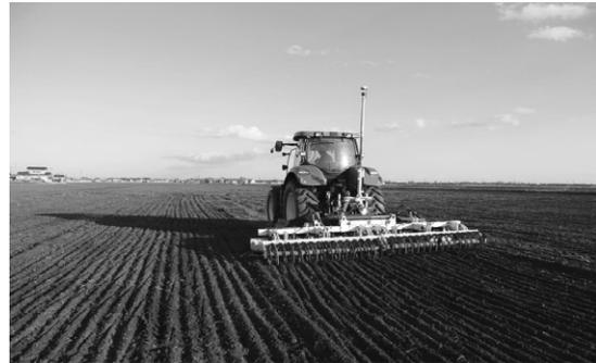
図5：GPS レベラーによる均平作業 (2013年3月5日)
