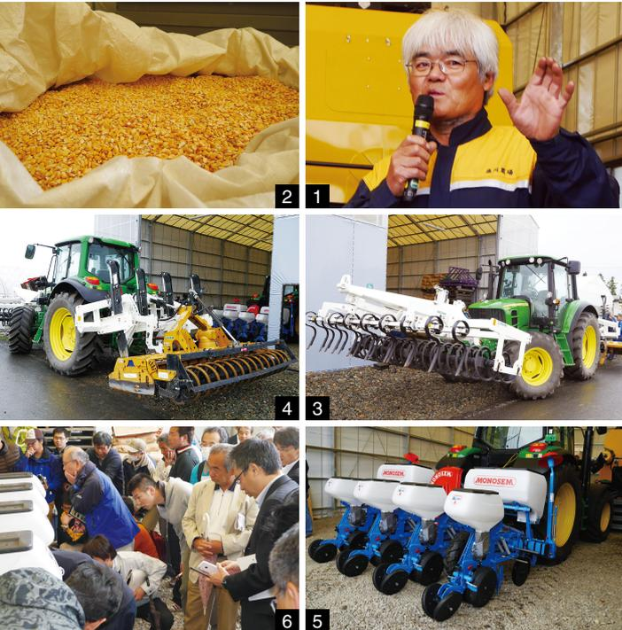
1 コンバインの前で説明をする盛川周祐氏。昨年、コンバインの購入により格納庫を新設した 2 昨年収穫した子実トウモロコシを参加者一同が見る機会を得た 3 スプリングとスパイラルローラー（いずれもスガノ農機株）をフロント作業機として装着したJD6430 4 作業深さを油圧で調整できるコンビソイラとパーチカルハローによる複合作業体系（いずれもスガノ農機株） 5 モノセムの真空播種機（国際農機株）。盛川農場では同型の播種機を大豆と水稻の乾田直播に使用している 6 見学会の様子。参加者らは熱心に展示機に見入っていた
