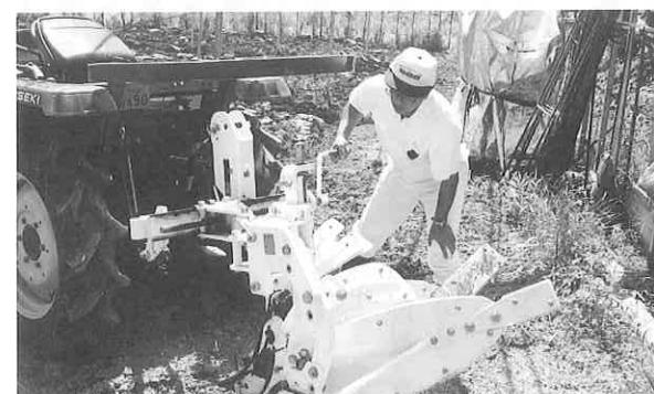
写真9 ボトムの高さ調整
