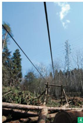
④林内には運搬用の索道が張りめぐらされている。⑤木々に滑車が固定され、効率的な順路で索道が張られている。設置を誤ると作業効率を著しく悪化させるため、段取りや設置場所を見極めなければならない。熟練した技術が必要だ。こうした作業習慣を身に付けることが、水田経営の省力化にもつながっている。⑥材木の伐り出しは、常に危険と隣り合わせ。家族で息を合わせて作業にあっている。
