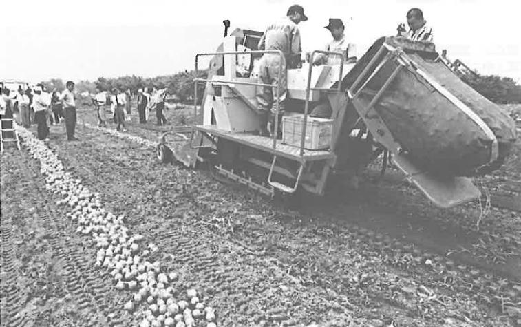
写真右上：オニオンハーベスターでのタッピング（茎葉処理）の様子を見る参加者。条列放出は機体後方及び側方に放出できる。経営実験は、生産者だけではなく流通消費業界の人々に農業生産技術の現状と将来性を理解してもらうことを目的の一つだ。
