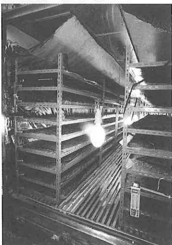
コンテナを使った冷蔵庫内にはホイスドで自動的に上下し、棚に積み込まれた苗に人工光を照射する設備。これも中村さんのアイデアだ
