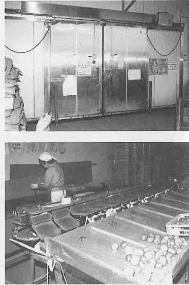
今年導入した真空予冷の装置（右）。左は大型予冷库とトマトの選別機
