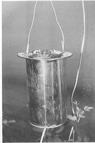
レフランプとステンレスの灰皿を利用した手製の硫黄燻蒸器
