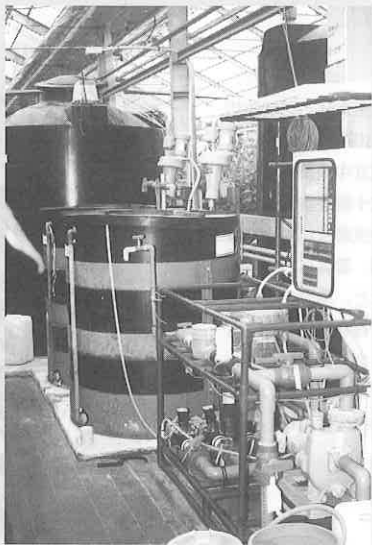
高平さんはカネコ種苗の養液システムを導入している。コントロールユニットは事務所のコンピューターと直結し、肥培管理が行われている
