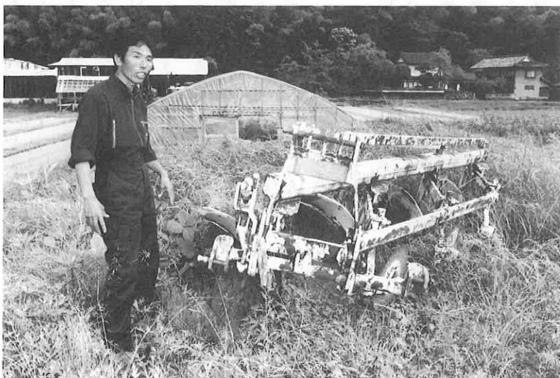
20年近く使っている畑作プラウ。石が多いため、このくらいの大きさがないと耕すという意味合いで土づくりはできない
