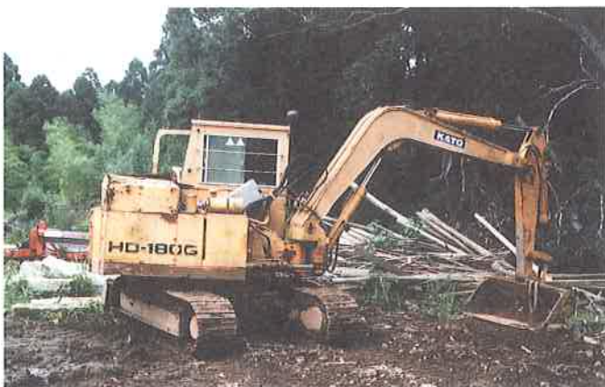
飯田さんは堆肥の攪拌に建設用のユンボを使用している。建設機材は往々にして農業機材に比べ安く、メンテナンスもし易い
