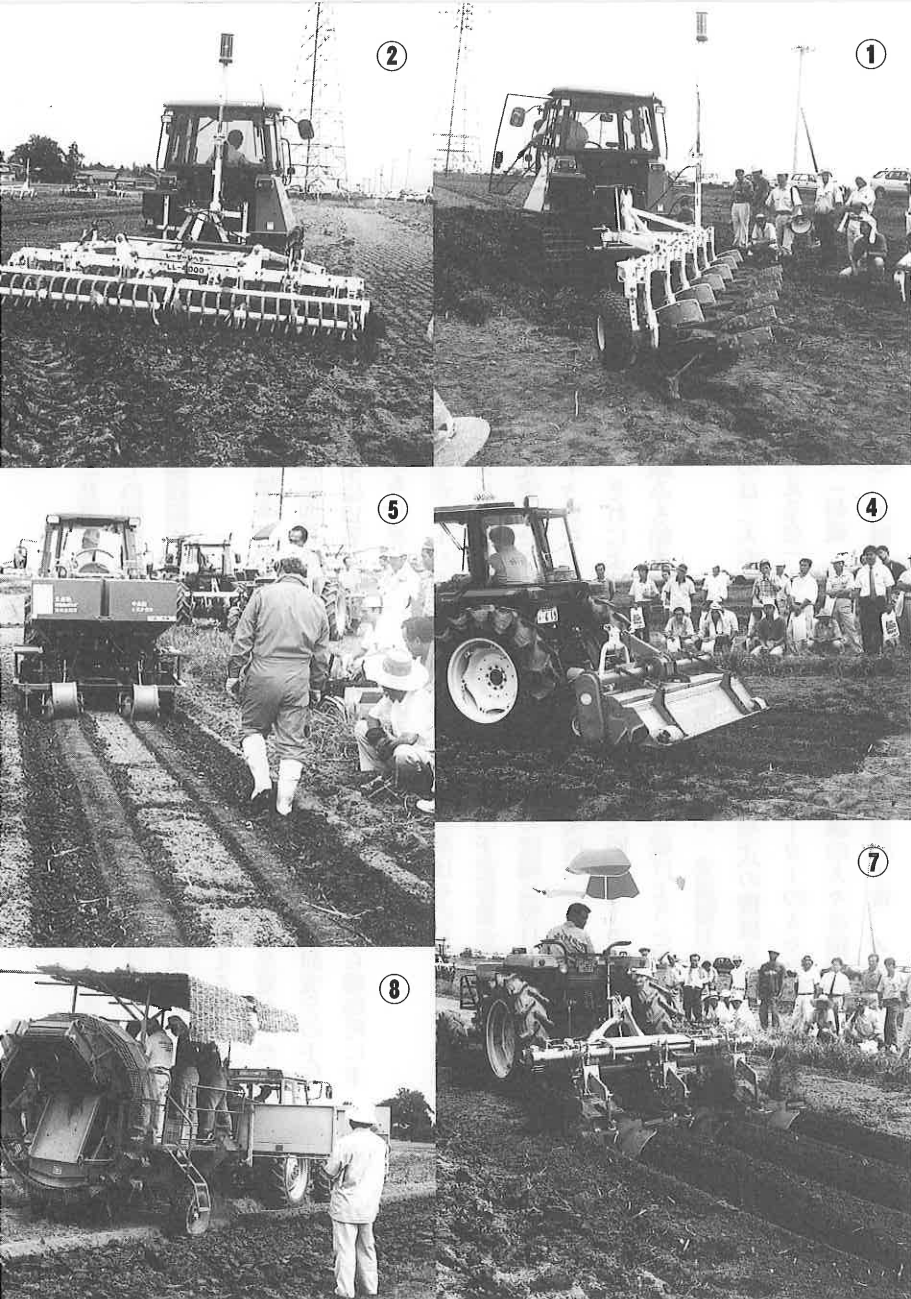
平成11年8月20日、FFCが中心となって行った実演検討会には多数の企業の協力があつた。同時に、同研究会では同グループが取り組むバレイショを中心に水田での畑作野菜経営を実現する様々な機械の実演がなされた。写真は①レーザーブラウ、②レーザーレベラー、③明渠掘機などの田畑輪換を容易化する機械類（以上スガノ）から、④砕土を確実にするロータリ（松山）、⑤植付けのためのポテトプランタ（日農機）、⑥大豆にも有効なカルチベータ（日農機）、⑦同じく高畦培土器をセットしたロータリカルチ（松山）、⑧牽引式のポテトハーベスタ（東洋）および⑨タマネギ収穫とも兼用できるポテトのピックアップハーベスタ（松山）などが村井信仁氏の解説で実演された。
