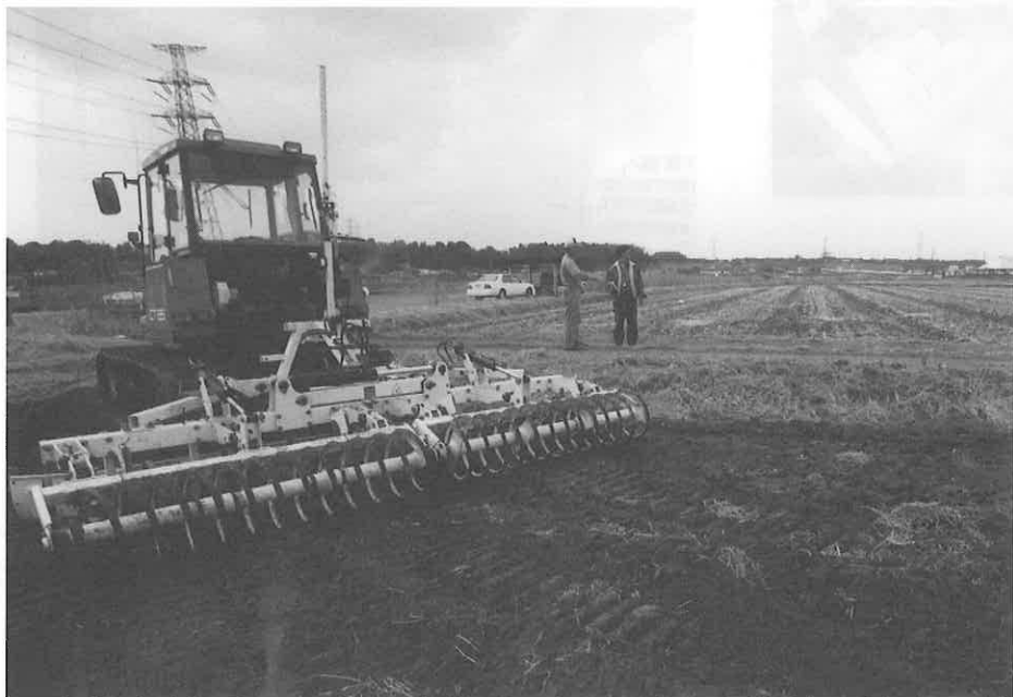
レーザーレベラーによる田面の均平は生産性、作業性の向上に計り知れない効果をもたらした。区画は1ha。
