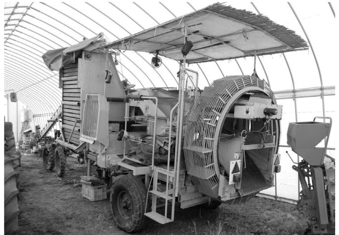
▲藤見鉄工所のポテトハーベスタ「FPH-CA」。油圧を使用する巻き上げタイプのシュートは2006年に取り付けた。それまではコンテナローダーを使用。いずれも同社に依頼して製造してもらったものである。「ジャガイモでは打撲痕にいちばん神経を使う」
