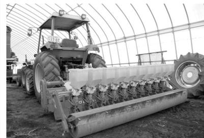
◀大麦とソバの播種に使用する小橋工業製10連プランタ「ND24-10」。「大麦とソバを輪作するので、大麦へのソバの混入を抑えるため、大麦の播種幅を狭くしている。この機種だと鎮圧ローラーが駆動軸として作動するため、8月の土が乾燥した時期にソバを播種すると、土をローラーで引き込んで種子が落ちなくなるのが欠点」
