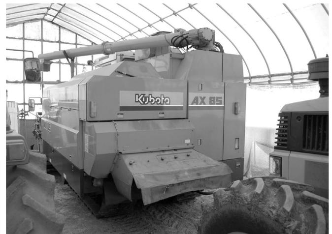
◀ソバの収穫に使用するクボタ製コンバイン「AX85」。運転席から作用部が目視できないため、同部を照らし出すライトを取り付けている。また、ソバの実がタンクの上部に詰まらないよう選別盤から出てきた実が1番昇降機からタンクへストレートに落ちる具合に改造が施してある。「メーカーに頼んでもやってくれないので自分でやった。改造は、農家間のネットワークによる情報交換から生まれることが多い。そうした仲間がいるかどうか重要になる」
