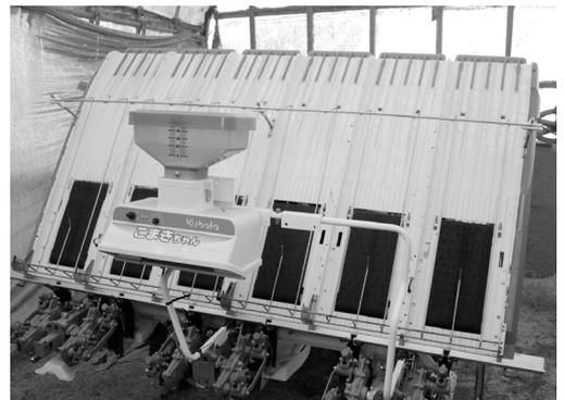
▲2007年に導入したばかりのクボタ製6条田植機「NSU67」。「有機肥料の側条施肥と除草剤の散布が田植えと同時にできるため、作業効率が良くなった。ただ、肥料の粒状が大きいため側条施肥機との相性が悪く、予定量が落ちなくて苦労した」
