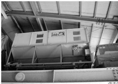
◀乾燥機はすべて金子農機製。使いやすさを統一したかったので同じメーカーにしたという。パーナード循環タイプが4台に、遠赤外線タイプが1台。受託作業をしている20~30aの生産者に1つずつ割り当てるような具合で使用している。「コメには遠赤外線がいいが、反対にソバは量が少なかったり、水分が多いと皮がむけるのでよくない」
