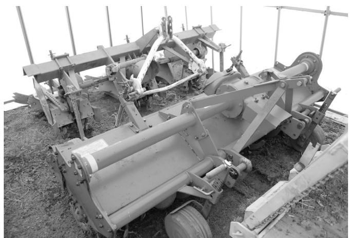
▲ジャガイモの培土作業では、大豆用の5連培土器を改造して作った3連タイプで作業していく。「いろいろといじくって尾輪を外し、培土羽根の角度を変えられるようにした」。羽根の角度を調整することで、霜よけや早期萌芽、緑化対策を実施しているという。
