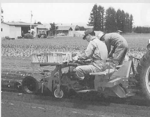
写真1 改造甜菜移植機による2号紙筒苗の移植
