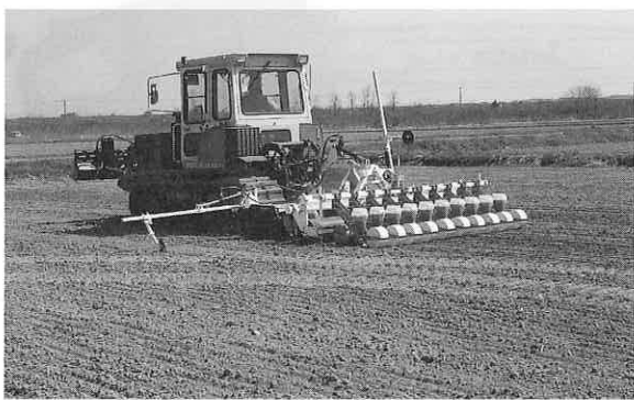
乾田直播による播種作業。株間15cm、1~3粒の点播で移植稲以上の生育をする（写真提供：スガノ農機）
