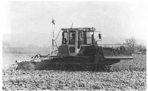
レーザーレベラによる均平作業。この作業が発芽を確実にし、除草剤使用を最小限のものにする (写真提供：スガノ農機)
