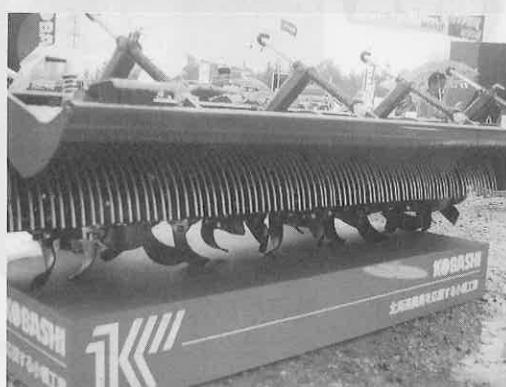
**写真2 アップカットロータリのスクリーン**
