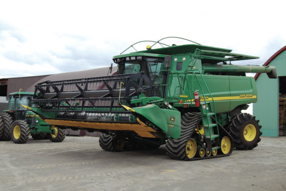
▲宮井自慢のジョンディアのゴムクローラ・コンバイン9750STS。360psのエンジンを搭載し、縦軸の脱穀部を持つタイプ。刈幅は5.4mで、麦の場合で1時間に2ha、大豆では5haを収穫できる。3500万円で購入した。部品をあらかじめ在庫しておけば問題はない。
