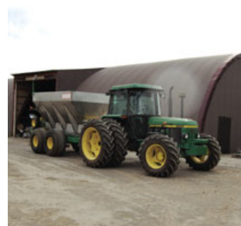
▲ダブルタイヤを履かせたジョンディア6600（110ps）でけん引するライムスプレッダ。米国製で8t積載できる。10mの幅で石灰から鶏糞までの散布が可能なこの機械を気に入っている。特に重量の大きな転炉スラグを撒くのに最適。
