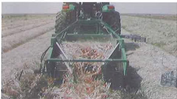
タマネギ用ディガの作業の様子。茎葉処理や根切りをしないでそのまま収穫する
