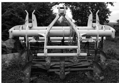
▲スガノ農機のスタブルカルチ。前処理としてプラウを入れた後、20〜25cmの深さで粗耕起する。もう少し幅の広いタイプが理想だが、圃場のアップダウンが激しいため、それなりの車速が出せないと作業が難しい。敢えて幅の狭いタイプで、早く走れるようにしている。
