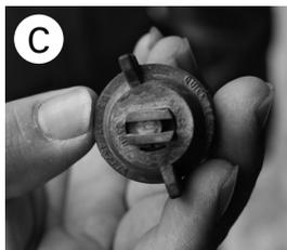
ブームスプレーヤーのノズルは用途によって使い分けている。Aはドリフト対応の低圧散布ノズル。ポジティブリスト制を見越して、5年前から導入した。Bは従来の通称「カニ目」ノズル。ポンプの圧力を20kg前後に上げる必要があり、弱い風でも簡単にドリフトしてしまう。Cは汎用性の高いXRノズル。土壌処理の除草剤や雪腐れ病の防除など、実際に薬液を付着させたいときに使用
