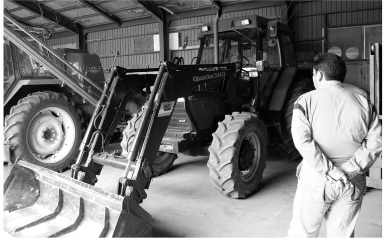
▲▶2000年に中古で導入したケースの90馬力トラクタ。重作業専用で、ビートハーベスタのけん引などに使用。冬は除雪も行なっている。フロントローダーは、ジャガイモの収穫時、フレコン（写真右）を運ぶために活躍する。
