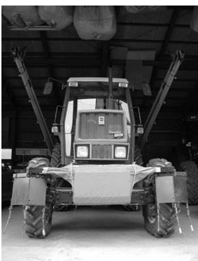
▶日農機の施肥カルチベータ。施肥タンクだけ最新のタイプに乗せ換え、ギアの組み換えて施肥量を正確に出せるようになっている。
