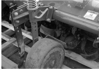
◀▼コバシのハイパーローター。タイヤの後に踏圧を解消するタイヤ消しが付いているだけでなく、ローター部分もタイヤの後だけ、タマネギ用の頑丈な四角いツメが付いている。土壌の硬い美瑛ならではの工夫と言える。
