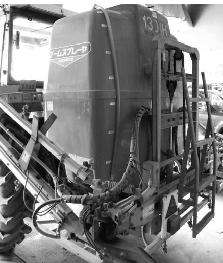
◀白金ダムの水を利用した多目的給水栓。写真左の1300ℓのスプレーヤも、6〜7分で満タンに。
