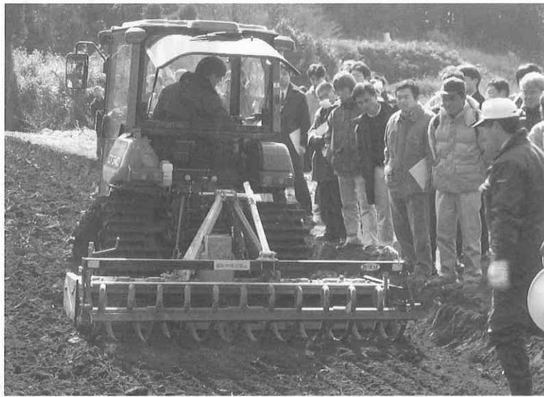
バーチカルハローBETA250SP（希望小売価格1,100,000円、消費税別。資料請求番号64）。ナイフブレードが垂直回転するので残渣をかき上げずに碎土・整地できる。その後をコイルローラーが鎮圧して理想的な播種床を造成する。
