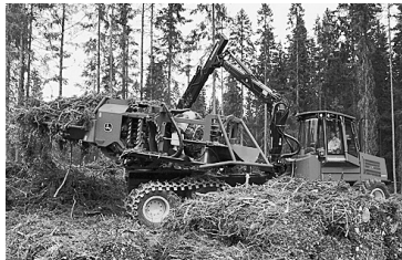
枝を梱包する装置をつけた、フィンランド製ジョン・ディア1490Dモデル。伐採跡地における枝の梱包作業では、最も汎用されている機械だ。
