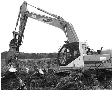
切り株を撤去する工程は、エネルギー収量を増加させるだけでなく、根の病害を減少させ、次の植林作業を始める準備となる。
