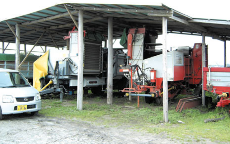
▲ジャガイモのハーベスタはオフセットタイプの東洋農機「TOP-1」と「TPH55」の2台を装備している。坂上さんはTOP-1を使っても、20a未満の畑でも無理無く作業できると話す。
