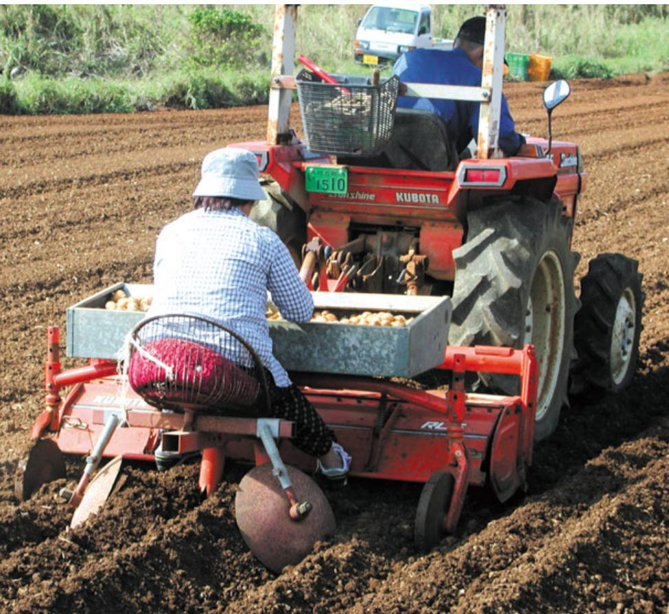
▲島そして冬作ゆえの季節風は栽培の大きな障害。沖永良部で一般的に使われている地場のプランタは、風による株傷みを防ぐために一畝に2条並木植えになるよう播種していく
