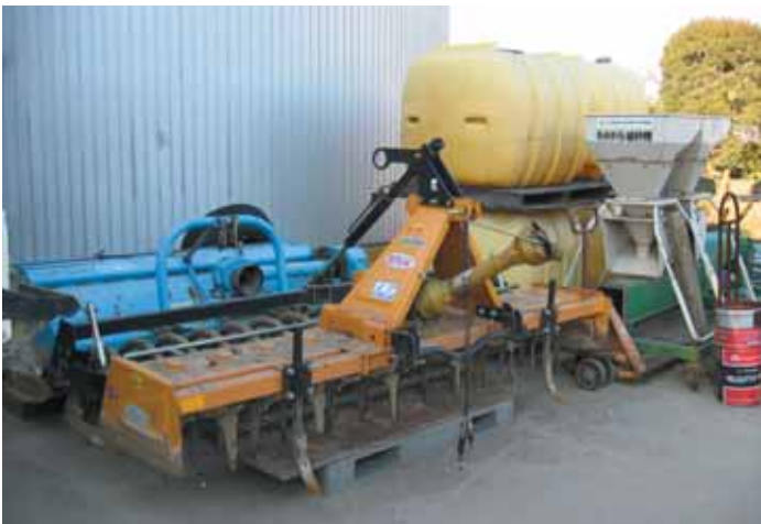
播種機をセットして乾田直播に使うバーチカルハロー。条間30cm、株間16cmで、1カ所当たり3〜4粒の点播する。
