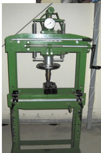
◀ベアリングの圧入などに使う油圧プレス。メカニック出身だけあって、格納庫には「工房」の雰囲気漂う。
