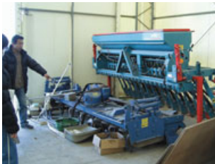
▲パーチャルハローに鎮圧ローラ、サルキーのニューマチックシーダ（12.5cm×25条）を組み合わせてある。作業幅は3m。この機械を妻の密条播に使用する。
