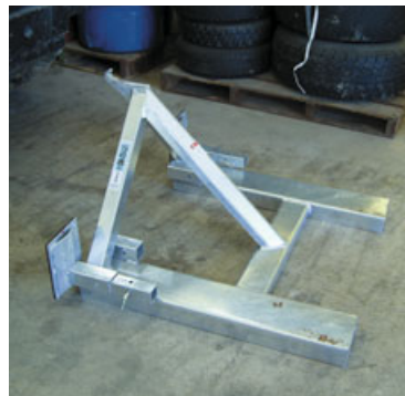
▲▶片岡氏が北海道の鍛冶屋さんから買ってきたもの。これをフォークリフトの先端に付けて作業機を持ち上げる。安全である。こんな掘り出し物もあるために、北海道にトラックで行くことも多い。十勝の友人から大豆の種子を譲り受けており、これを播くのも楽しみだ。 ◀片岡氏の自宅玄関。入口の脇に作業着を洗う洗濯機と流しを設置してある。ここではこりを落とし、作業着を洗濯機に投げ込んでから家に入るのだそうだ。
