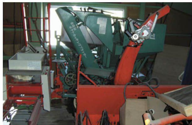
▶納屋の2階に収納してあった全自動のポテトプランタ（2畦）と除雪機。除雪機は雪を飛ばす方向をトラクタの上から油圧で変えられるように改造してある。除雪は自分のためだけでなく、冬場のボランティアである。
