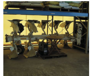
▼14インチ×7連のプラウ。150馬力のクロウラで水田作業を行なう。耕深は25cmだが、レベラで均平・鎮圧をするので水田は短靴でも入れる。このプラウもレーザーで深さの制御が可能で、耕深レベルでの均平もできる。レベラと組み合わせると2枚の田を1枚にするような作業にも使える。
