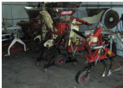
▲草刈る子（ニチノー） 63 にタバタの肥料ホッパを付けて、カルチ作業や培土と同時に追肥をできるように自分で改造した。
