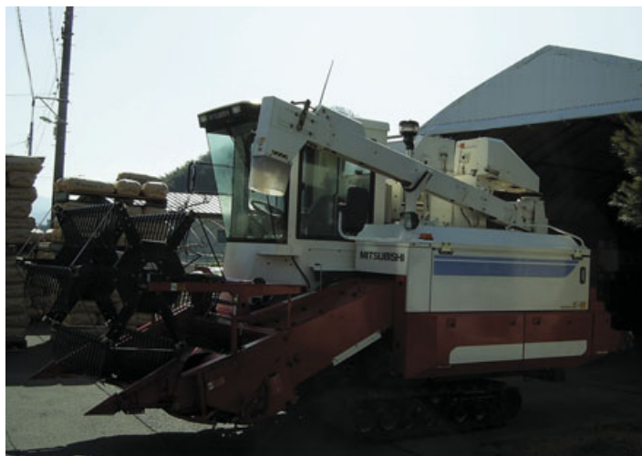
▲友人から譲り受けた汎用コンバインACH360（三菱・36ps） 62 。穀類搬送部が二番選元も含めてスクリーオーガではなく、コンベア式のため汚粒にならない。能力的な不満はあるが格安で買っているのでしょうがない。
