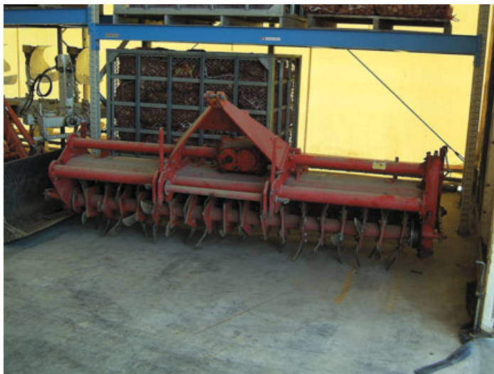
▲ロータリハロー（アグリック） 65 。以前はマスキオを使っていたが、このストレートなブレードの方が重粘土でも馬力も食わずに碎土率も高まる。茨城県の菊池鉄工所から20万円で購入。後ろのカゴロータで鎮圧するのも気に入っている。作業幅は2.5m。
