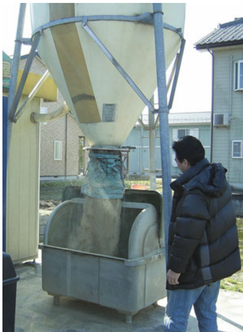
▶農機店から中古で買ったコイン精米機と糠のホッパ。糠の処理装置を付けていなかったのが追加装備した。格安で買ったものだが、結構な売り上げを稼いでくれるそうだ。
