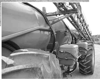
ゴールドイーカース社製のクアドラマックス型噴霧機は、6000ℓの主タンクを2つ搭載した全容量1万2000ℓの噴霧機。前面には化学薬品や微量元素を入れる一対のシャトル・タンクが取り付けられており、積載可能な液体の全容量は1万4,000ℓに達する。
