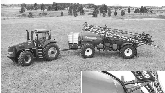
ゴールドイーカース社製のクアドラマックス型噴霧機は、6000ℓの主タンクを2つ搭載した全容量1万2000ℓの噴霧機。前面には化学薬品や微量元素を入れる一対のシャトル・タンクが取り付けられており、積載可能な液体の全容量は1万4,000ℓに達する。
