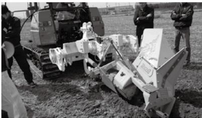
モミサブロー+ハーフソイラ+ロータリー溝掘機の複合作業
