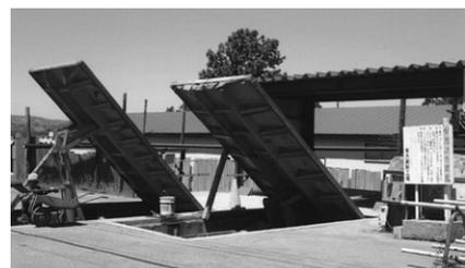
小規模工場であるだけに無駄な投資は許されない。受け入れ場のトラック傾斜台は廃車になった10tダンプトラックの荷台を利用したものである。平ボディのトラック搬送でも迅速に荷降ろしができる。
