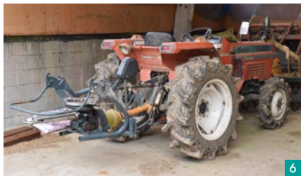
5 補助事業で導入したスター農機のマニアスプレッダ（容量：3t）。クローラーを後付けした。 6 7 土壌改良剤として、毎年投入しているミネカルを散布するためのスパウト式のブロードキャスター（容量300kg）と26馬力のキャビンなしトラクター。ミネカルは製鉄クズなので、機械を摩耗させるのが難点だ。50t程度散布すると穴が開くので、スパウト部分を樹脂製からステンレス製に交換した。
