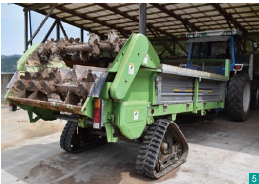
5 補助事業で導入したスター農機のマニアスプレッダ（容量：3t）。クローラーを後付けした。 6 7 土壌改良剤として、毎年投入しているミネカルを散布するためのスパウト式のブロードキャスター（容量300kg）と26馬力のキャビンなしトラクター。ミネカルは製鉄クズなので、機械を摩耗させるのが難点だ。50t程度散布すると穴が開くので、スパウト部分を樹脂製からステンレス製に交換した。
