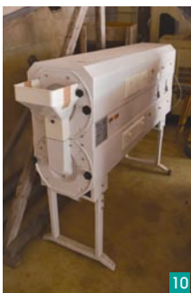
10 種子選別用に使っているサタケの横型選別機。選択した理由は①シンプルで壊れない、②落とす米粒が多くても問題がないという2点。夢はずくは大粒品種なので、2.4mmで、ほかの品種は2.3mmで2～3回選別機にかける。
