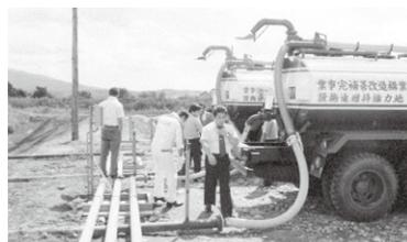
散布作業能率を高めようとする、いかにポテトジュースの積み込みを短時間に行なえるようになるかがポイントである。ホースの脱着を円滑に行なえるようにし、バルブの開閉も簡単に操作できるようにしたことで、極めて短時間に積み込みができるようになった。
