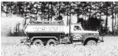
馬鈴薯を磨砕してからまずこれを固液に分ける。液体をポテトジュースと呼んでいるが、BOD 2万ppmと濃厚であるので、これを畑地に散布還元する。でん粉工場で使った水は池に貯溜し、曝気発酵処理で浄化して河川に放流するが、先にポテトジュースを処理しておけば、その処理が容易である。
