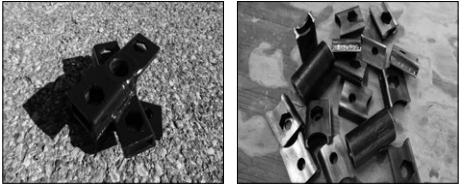
(左) 塗装して仕上がった爪ホルダー (右) 溶接前のシャフトとソケット
