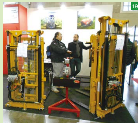
▶トラクターの3点リンクに装着可能なSAE社のリフト。果樹園用の小型トラクターにも装着できるサイズまでラインナップがあり、トラクターに外部油圧があれば使える。小型トラクターにも対応可能な作業機も、意外と種類が豊富。前後逆のトラクターとなら、特に相性が良さそう
