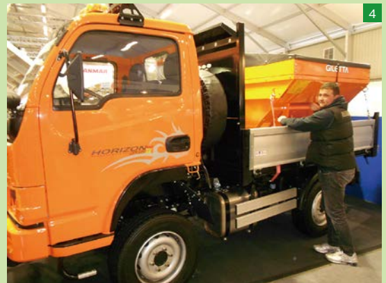
▲融雪剤散布用のトラック。前方に角度を調節できる除雪用の排土板を装着し、融雪剤散布用のブロードキャスターが荷台に載っている。タイヤが華奢に思えたが、実用的である
