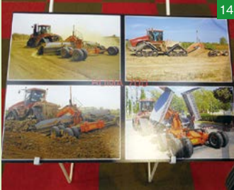
▲◀Montefiori社の巨大なレーザーレベラー。排土板は腰の高さまであり、巨大だ。300馬力以上のトラクターが必要だとか……。均平をとる仕組みは、我々が使っているものと同じだが、牽引用のタイヤを見ればわかるように、何しろ部品もゴツイ!
