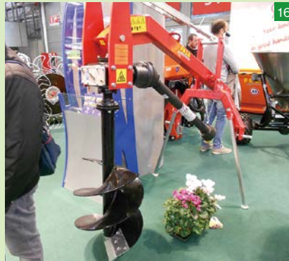
▶イタリアでは圃場周辺、農道の整備は農場が自ら行なうため、トラクターを多目的に利用するための道具が実に多種多様に存在する。これは、Faza社の穴掘り機! 3点リンクで装着し、PTOの回転動力をそのまま利用するようだ。建物の杭打ちにも、下穴掘として利用しているのだろう
