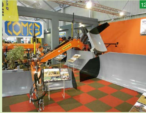
▲◀Montefiori社の巨大なレーザーレベラー。排土板は腰の高さまであり、巨大だ。300馬力以上のトラクターが必要だとか……。均平をとる仕組みは、我々が使っているものと同じだが、牽引用のタイヤを見ればわかるように、何しろ部品もゴツイ!
