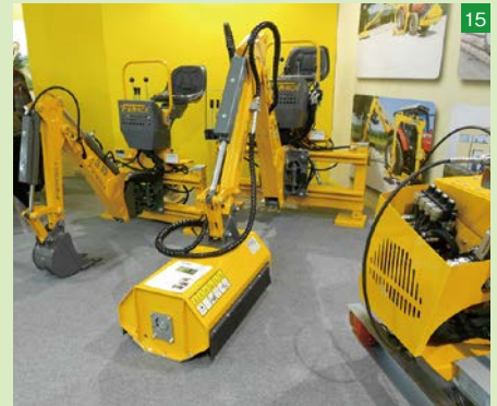
▲イタリア・FEMAC社のミニショベル&シュレッダー。キャビンなしのシンプル機構で、日本でも個人で所有できるサイズだろう。自前でなんでもやってしまう気合いをここからも感じる
