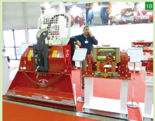
▲イタリア・DAL POZZO社のハンドリング機器。トラクターに装着し、動力を油圧で取り出す機構だ。ウインチのパワー、位置、牽引力により、アタッチメントの形状を多様に展開している。どう使われるか想像がつかないので、現場作業を見てみたい
